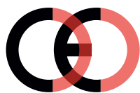
Faux marquage CE (trop proche)
